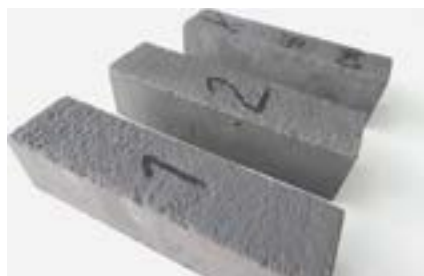
Фото 11. Контрольные образцы для испытаний сульфатостойкости по ГОСТ 27677-88 после 3 месяцев испытаний в агрессивной среде
