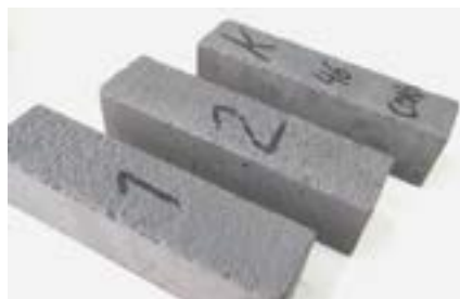
Фото 15. Контрольные образцы для испытаний сульфатостойкости по ГОСТ 27677-88 после 4 месяцев испытаний в агрессивной среде
