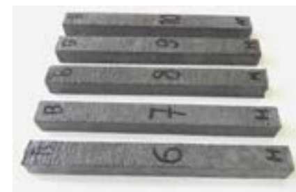
Фото 18. Образцы для испытаний сульфатостойкости по ГОСТ Р 56687-2015 после 5 месяцев испытаний в дистиллированной воде
