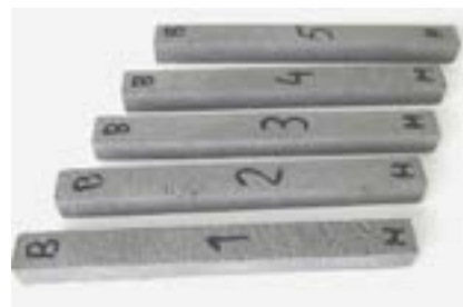
Фото 21. Образцы для испытаний сульфатостойкости по ГОСТ Р 56687-2015 после 6 месяцев испытаний в агрессивной среде
