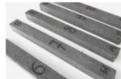
Фото 6. Образцы для испытаний сульфатостойкости по ГОСТ Р 56687-2015 после 2 месяцев испытаний в дистиллированной воде
