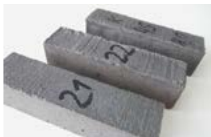
Фото 12. Контрольные образцы для испытаний сульфатостойкости по ГОСТ 27677-88 после 3 месяцев испытаний в питьевой воде
