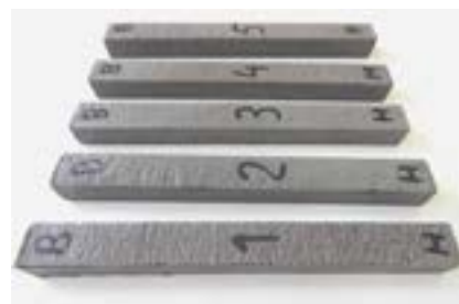
Фото 17. Образцы для испытаний сульфатостойкости по ГОСТ Р 56687-2015 после 5 месяцев испытаний в агрессивной среде
