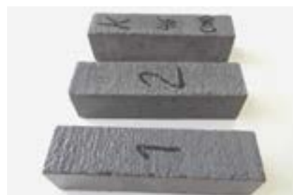
Фото 19. Контрольные образцы для испытаний сульфатостойкости по ГОСТ 27677-88 после 5 месяцев испытаний в агрессивной среде
