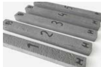
Фото 9. Образцы для испытаний сульфатостойкости по ГОСТ Р 56687-2015 после 3 месяцев испытаний в агрессивной среде
