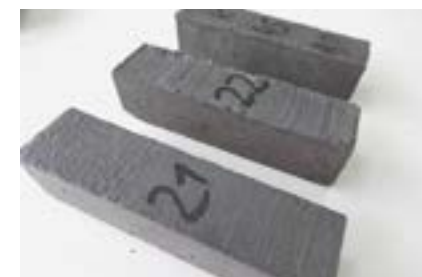
Фото 8. Контрольные образцы для испытаний сульфатостойкости по ГОСТ 27677-88 после 2 месяцев испытаний в питьевой воде
