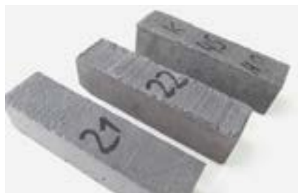
Фото 16. Контрольные образцы для испытаний сульфатостойкости по ГОСТ 27677-88 после 4 месяцев испытаний в питьевой воде
