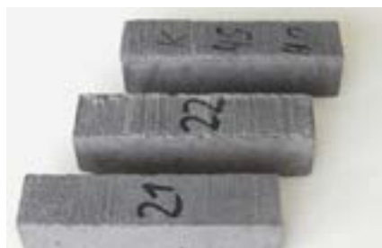
Фото 24. Контрольные образцы для испытаний сульфатостойкости по ГОСТ 27677-88 после 6 месяцев испытаний в питьевой воде
