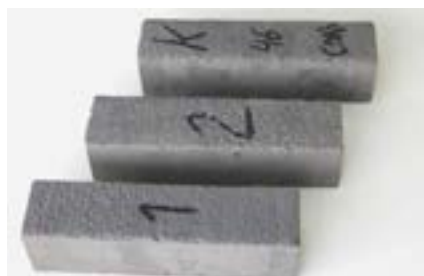
Фото 23. Контрольные образцы для испытаний сульфатостойкости по ГОСТ 27677-88 после 6 месяцев испытаний в агрессивной среде
