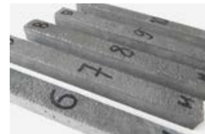
Фото 10. Образцы для испытаний сульфатостойкости по ГОСТ Р 56687-2015 после 3 месяцев испытаний в дистиллированной воде
