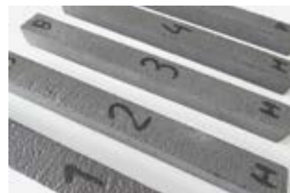
Фото 5. Образцы для испытаний сульфатостойкости по ГОСТ Р 56687-2015 после 2 месяцев испытаний в агрессивной среде
