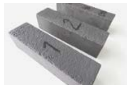
Фото 7. Контрольные образцы для испытаний сульфатостойкости по ГОСТ 27677-88 после 2 месяцев испытаний в агрессивной среде
