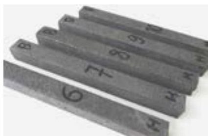
Фото 14. Образцы для испытаний сульфатостойкости по ГОСТ Р 56687-2015 после 4 месяцев испытаний в дистиллированной воде
