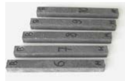
Фото 22. Образцы для испытаний сульфатостойкости по ГОСТ Р 56687-2015 после 6 месяцев испытаний в дистиллированной воде
