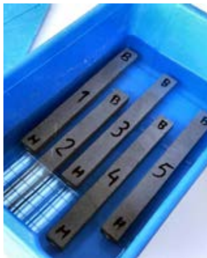
Фото 3. Хранение образцов в емкости для испытаний сульфатостойкости по ГОСТ Р 56687-2015
